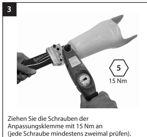
Ziehen Sie die Schrauben der Anpassungsklemme mit 15 Nm an (jede Schraube mindestens zweimal prüfen).
