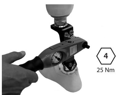
Breng Loctite (243) aan en zet de bouten van de bovenbehuizing vast (25 Nm). Montere de koker en lijn deze uit.
