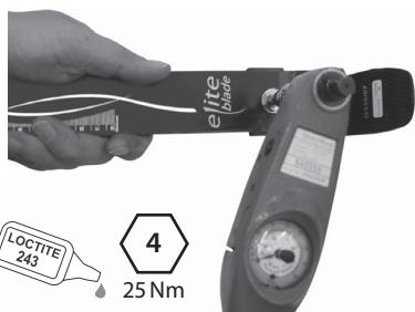
Připevněte pylon k patnímu nosiči. Naneste Loctite (243) a utáhněte šroub (25 Nm).
