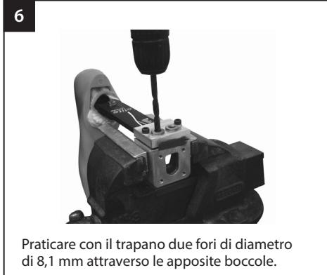
Praticare con il trapano due fori di diametro di 8,1 mm attraverso le apposite boccole.
