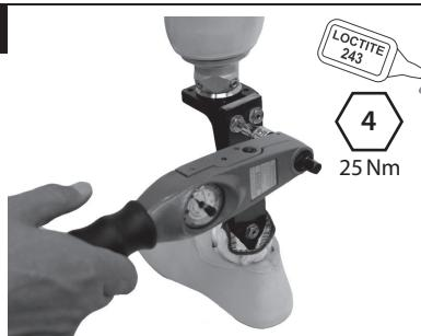
Tagliare il pilone utilizzando il metodo precedentemente illustrato prima di fissare l'alloggiamento superiore. Applicare Loctite (243) e serrare i bulloni (25 Nm). Se necessario, riapplicare le finiture cosmetiche.
