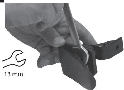
Retire a lâmina posterior do suporte.
