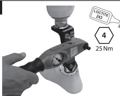
Před připevněním horního pouzdra uřízněte pylon způsobem, který je znázorněn výše. Naneste Loctite (243) a utáhněte šrouby (25 Nm). Pokud je to možné, znova použijte kosmézu.
