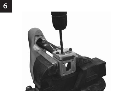
Boor twee gaten met een diameter van 8,1 mm door de booropeningen.
