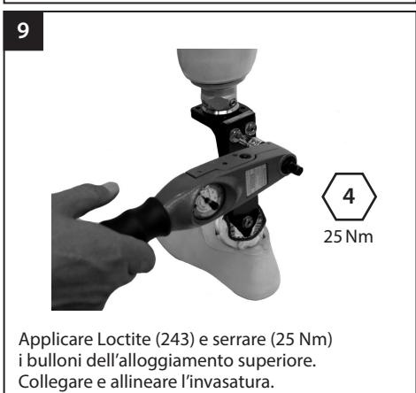
Applicare Loctite (243) e serrare (25 Nm) i bulloni dell'alloggiamento superiore. Collegare e allineare l'invasatura.
