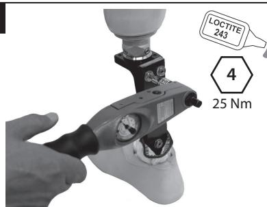
Antes de colocar a estrutura superior, corte o pilão utilizando o método mostrado anteriormente. Aplique Loctite (243) e aperte os parafusos (25 Nm). Volte a aplicar o revestimento cosmético, se aplicável.
