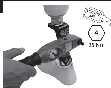
Coupez le tube selon la méthode indiquée précédemment avant de fixer le boîtier supérieur. Appliquez du Loctite (243) et serrez les boulons (25 Nm). Appliquez à nouveau le revêtement esthétique, si nécessaire.
