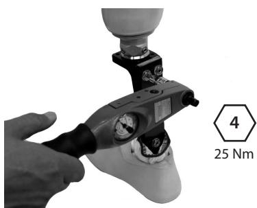
Nanożyć klej Loctite na gwinty (243) i dokręcić (25 Nm) śruby górnej obudowy. Zamontować i wyosiować lej.
