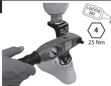
Snij de pyloon af met behulp van de eerder weergegeven methode en bevestig de bovenbehuizing. Breng Loctite (243) aan en zet de bouten vast (25 Nm). Breng nogmaals cosmese aan indien nodig.
