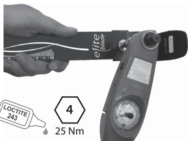
Verbinden Sie den Pylon mit dem Fersenträger. Tragen Sie Loctite (243) auf, und ziehen Sie die Schraube an (25 Nm).
