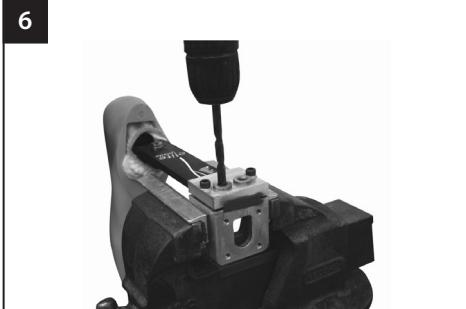
Realize dois orifícios com 8,1 mm de diâmetro através das guias de perfuração.
