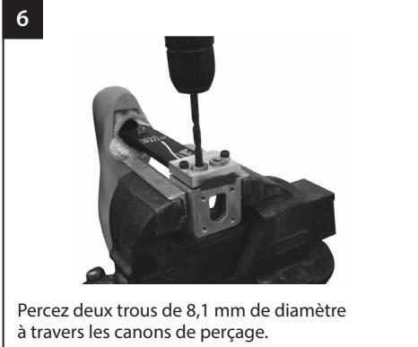
Percez deux trous de 8,1 mm de diamètre à travers les canons de perçage.
