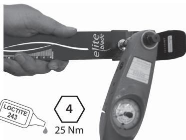
Fixez le tube au support du talon. Appliquez du Loctite (243) et serrez le boulon (25 Nm).
