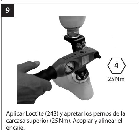
Aplicar Loctite (243) y apretar los pernos de la carcasa superior (25 Nm). Acoplar y alinear el encaje.
