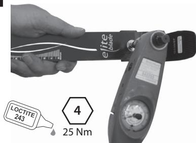
Fixe o pilão ao suporte do calcanhar. Aplique Loctite (243) e aperte o parafuso (25 Nm).
