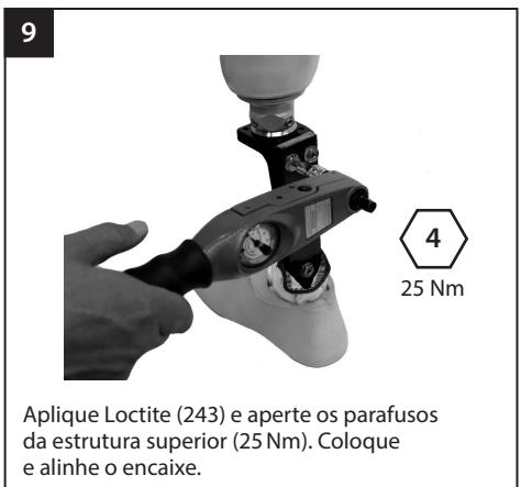
Aplique Loctite (243) e aperte os parafusos da estrutura superior (25 Nm). Coloque e alinhe o encaixe.
