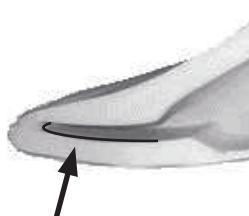
Posizione della lamina anteriore all'interno del rivestimento del piede.
