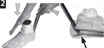
Fessura per l'alloggiamento della lamina del tallone
